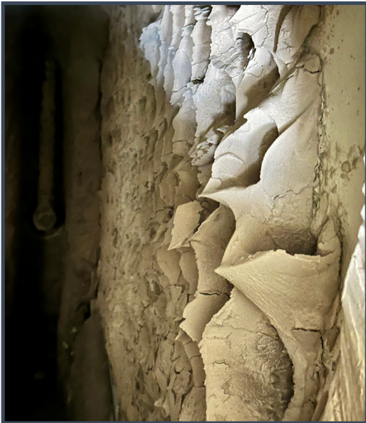
Acúmulo de fuligem e cinzas na chapa tubular.
