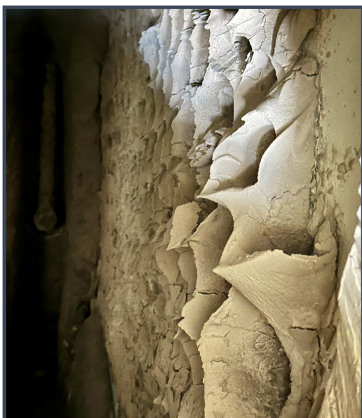
Accumulation de suie et de cendres au niveau de la plaque tubulaire.
